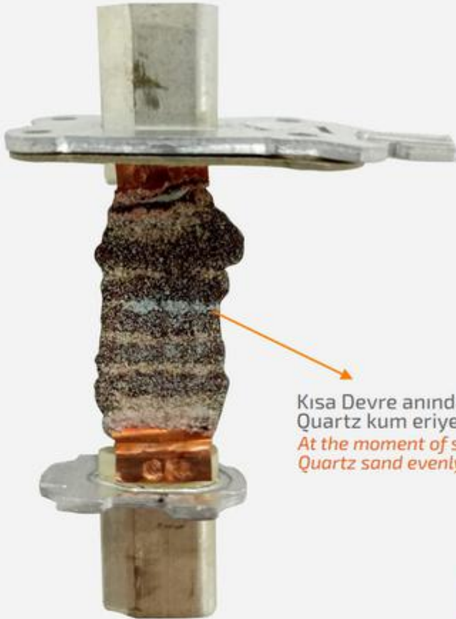
Kısa Devre Şartlarında Açma Yapmış Ürün Opened Fuse Under Short Circuit Conditions
